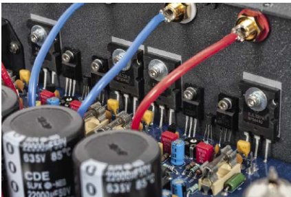
Wydaje się, że tranzystory wyjściowe (ON Semiconductor – 2 pary) przykręcono do tylnej ścianki, tymczasem na zewnątrz jest jeszcze spory radiator.
